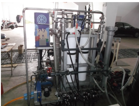
10CMD 小型海淡機組已經進入試運轉狀態。
