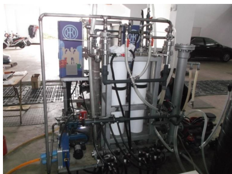
10CMD 小型海淡機組已經進入試運轉狀態。
